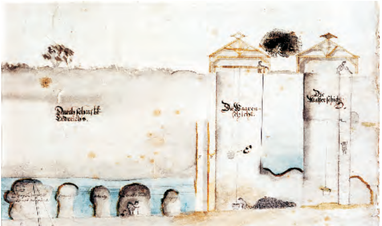
Abb. 9.2-2: Querschnittdarstellung der „Herrschaftlichen Kohlenbaue zu Burgk“ von 1774 mit einem Waaren- und Wasserschacht und dem Anschluss an einen Stollen = „Alter Schacht“ der Burgker Steinkohlenwerke. Besonderheiten: links das Tiefe Fallort mit Linien (Marscheiderzug oder Seilzug?), mehrere Weitungsbaue ohne Ausbau, im „Alten Fall“ Kohlenhucker, am Waarenschacht ausgekippte Kohle, die am „Füllort“ in Tonnen gefüllt, durch Haspel gefördert und mit Karren zum Stapel gefahren wurde. Im Wasserschacht nur ein Kübel am Haspelseil, rechts vom Haspel die „Hornstatt“ für das Haspelhorn und zum Auskippen in einen Stollen. Daneben der Fahrschacht mit „Fahrten“ und Verschlussdeckel. Original Slg. SSB
