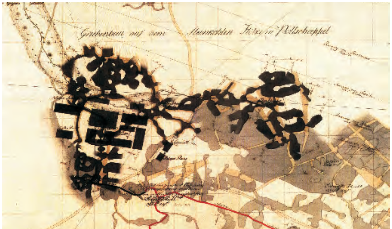
Abb. 13-3: Weitungsbaue zur Gewinnung sulfidreicher Steinkohlen und Lage der Vitriolsiederei im oberen Geiersgraben, Freital-Zschiegde; Hauptgrundriss Potschappeler Steinkohlenwerke (etwa 1810), Platte XIX / VIII Original - M.: 1 : 817, Archiv SSB
