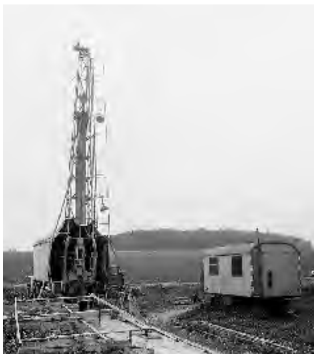
Abb. 10-6: Fahrbare Bohranlage UKB 500S (Bohrmaschinentyp SBA 500 auf URAL 375), Teufenkapazität: 500 m Foto: MORGENSTERN
