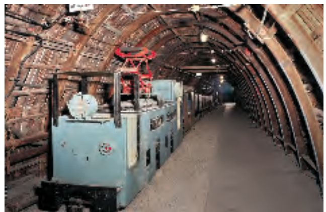
Abb. 14.9-5: Bergbaudenkmal : Oberleitungslokomotive vom Typ EL 6 in einer Strecke mit Stahlausbau Typ A 22 (12,5 m 2 ). Schauanlage Städtische Sammlungen Freital; Foto: SSB
