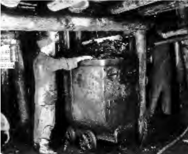
Abb. 9.2-17: Huntefüllung über Schüttelrutsche, Hunt nicht vom Typ Döhlen. Im Hintergrund links Mannschaftslampe und Steckbrett zum Huntzählen sowie Hinweisschild „Weißeritz Sicherheitspfeiler“, Schacht 2 (Unt. Revier); Foto: Deutsche Fotothek Dresden Nr. 104423
