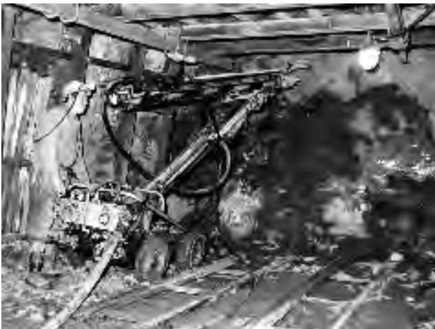
Abb. 10-7: Gleisloser Bohrgeräteträger im Streckenvortrieb; Foto: SDAG Wismut
