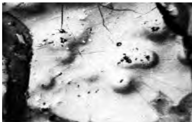
Abb. 4-8: „Warzenkohle“, frühdiagenetische Umlagerung und Konzentration von Uran in radioaktiven „Höfen“, verm. 5. Flöz, Gf. Gittersee. Bildbreite 0,6 mm; nach TZSCHOPPE 1960: Bild 25
