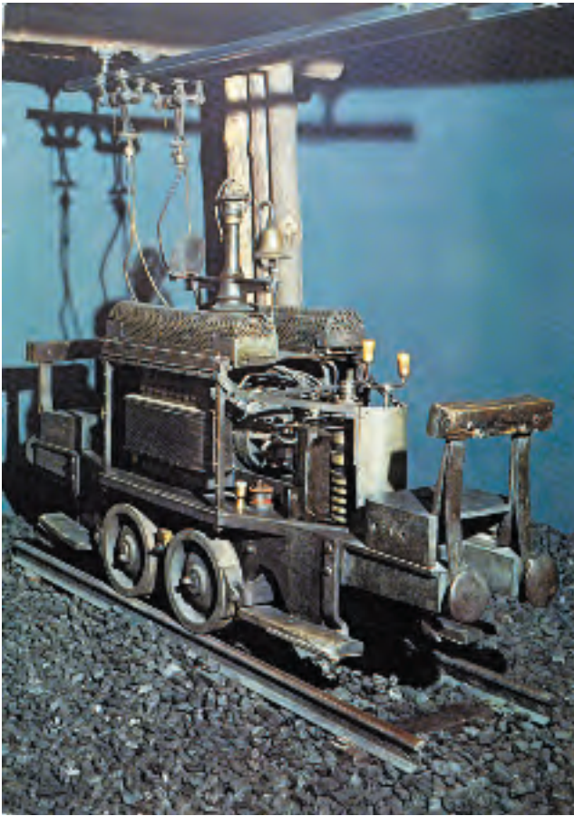
Abb. 14.4-4: Bergbaudenkmal : Erste elektrische Grubenlokomotive „Dorothea“ von SIEMENS & HALSKE Berlin, Baujahr 1882. Aufstellung im Werner von SIEMENS Forum München. Nach Ausleihe Präsentation in den Städtischen Sammlungen Freital im Schloss Burgk; Foto: Siemens AG München (Postkarte)
