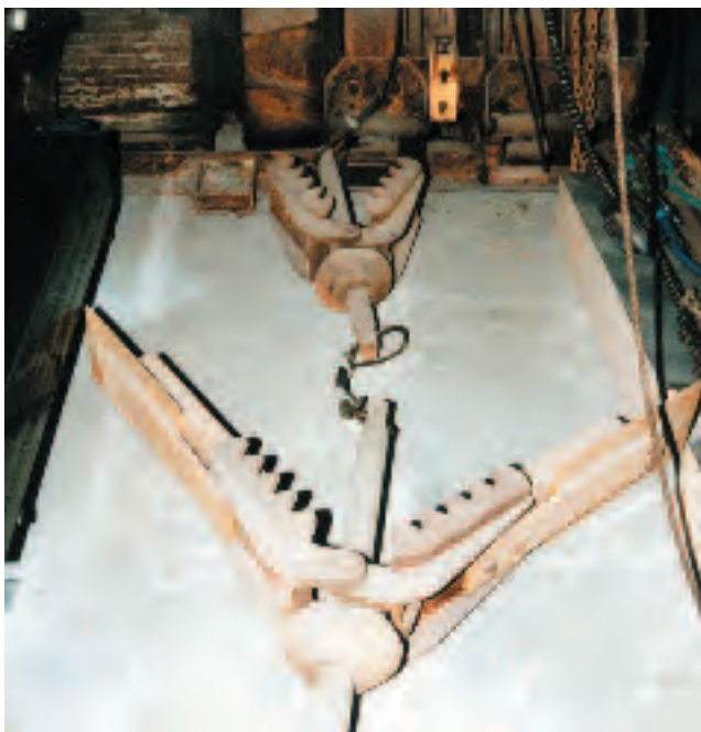
Abb. 10-16: Mehrgefäßschrapper für Abbauhöhen ab 1 m, speziell im 3. Flöz installiert, Schauanlage Städt. Samml. Freital; Foto: SCHAUER
