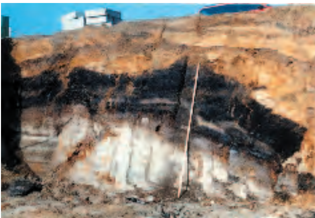
Abb. 3.2-28: Döhlen-Formation, 3. Flöz mit dem dunklen Leithorizont im Hangenden. Grobklastisches Lgd., links ein Kamm, rechts Flöz abgerissen und deformiert durch Bruch von Abbauen des 5. Flözes. Meßlatte 3,5 m. Baugrube 2, NW Ecke, östl. G.-KLIMPEL-Straße, Freital-Zuckerode. März 1997; Foto: REICHEL
