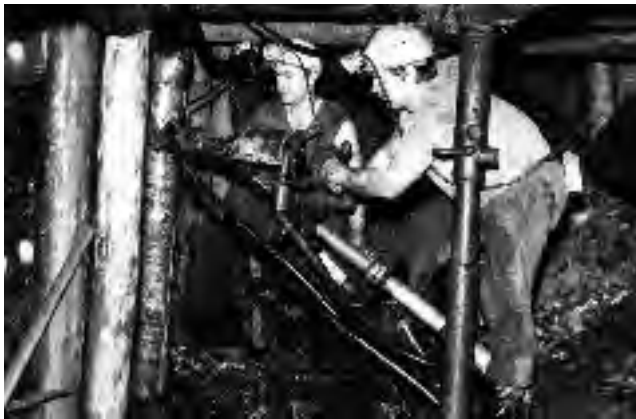
Abb. 10-14: Bohrarbeit mit Bohrstütze im Abbau; Foto: SDAG Wismut
