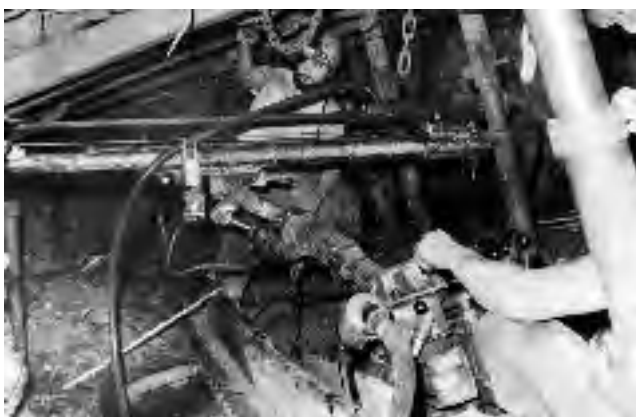
Abb. 10-15: Bohrgeräteträger im Abbau; Foto: SDAG Wismut
