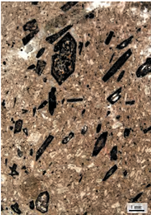
Abb. 3.1-8: Dünnschliff Porphyrit im Durchlicht Stbr. Osterberg (Eichberg); Bearbeitung und Foto: J.-M. LANGE (MMG)
