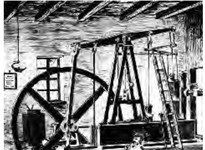
Abb. 14.4-15: Maschinenstube der Burgker Dampfmaschine am Erdmann Schacht. Burgker Steinkohlenwerke. Freital-Burgk, Windberg Allee, Zeichnung von RABENER, Original SSB
